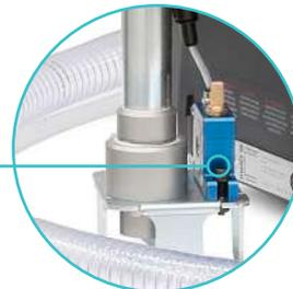
Ensemble rabattable pour accéder à l'intérieur du réservoir de l'unité de fusion, avec détection magnétique de la fermeture
