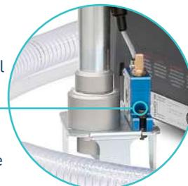
Conjunto abatible para el acceso al interior del depósito del fusor con detección magnética de cierre
